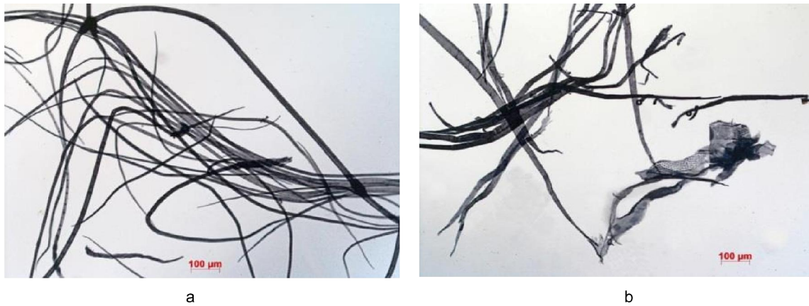
Hình 5. Hình ảnh hiển vi sợi cellulose ở độ phóng đại 100 lần: a - tre; b - Bạch dương
