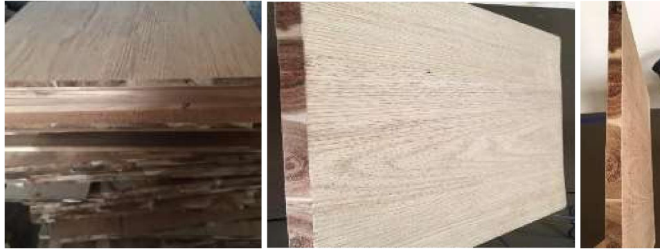
Hình 2. Ép phủ mặt ván ghép thanh gỗ keo lai bằng ván lạng gỗ Sồi đỏ
