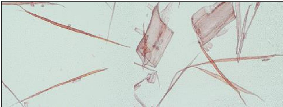
Hình 4. Sợi gỗ và ống mạch của gỗ Bàng lãng
