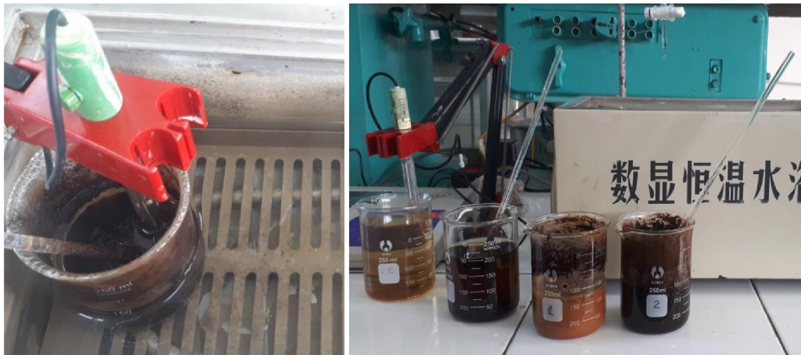
Hình 3. Kết tủa và dịch đen khi nhỏ axit sunfuric
