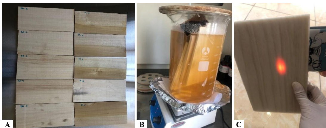
Hình 1. Một số hình ảnh mẫu thí nghiệm A. Mẫu gỗ Mỡ và gỗ Bồ đề; B. Tẩy trắng mẫu thí nghiệm; C. Hiện tượng thấu quang của gỗ sau khi tẩy trắng
