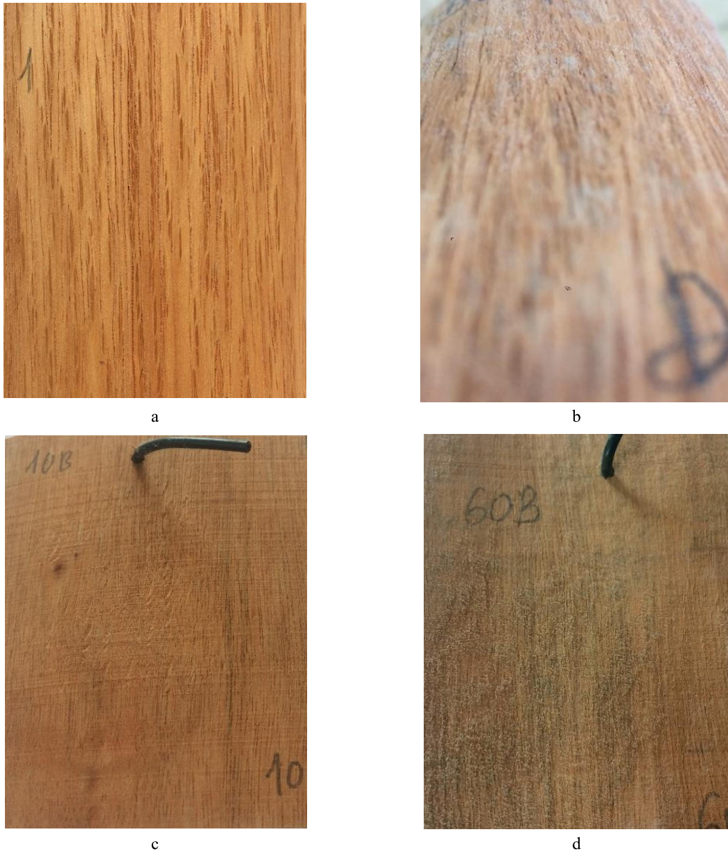
Hình 1. Mẫu ván lạng Dẻ đỏ xử lý bảo quản (a), ván lạng Dẻ đỏ không xử lý bảo quản (b), ván bóc Bời lời vàng xử lý bảo quản (c), ván bóc Bời lời vàng không xử lý bảo quản (d) sau khi thử nghiệm với nấm mốc
