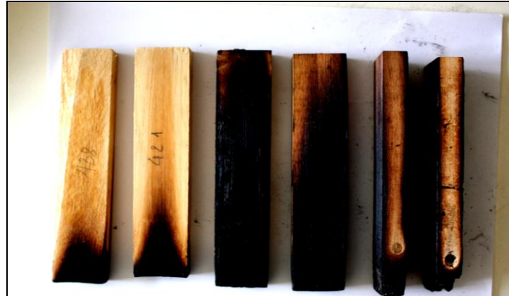
Hình ảnh mẫu thử chống cháy - mẫu có khả năng chống cháy, không bị cháy lan (1); mẫu bị cháy lan trên bề mặt (2) nhưng không bị lửa xâm nhập sâu (3)
