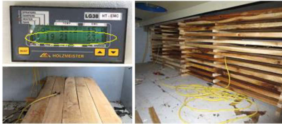
Hình 3. Đầu đo độ ẩm của đồng hồ sấy nối với bộ hiển thị 31, 19, 21, 23,1 - độ ẩm gỗ tại 3 đầu đo và trung bình; 35,2 - nhiệt độ sấy; 15.0 - EMC
