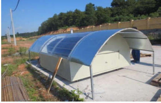
Hình 1. Lò sấy gỗ thí nghiệm sử dụng năng lượng mặt trời
