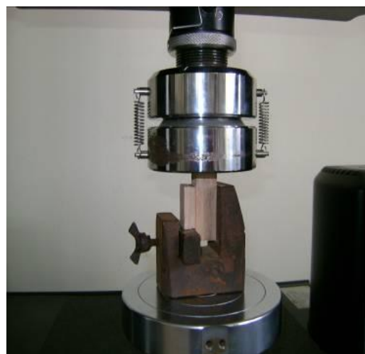
Hình 1. Gá lắp mẫu thử trượt
