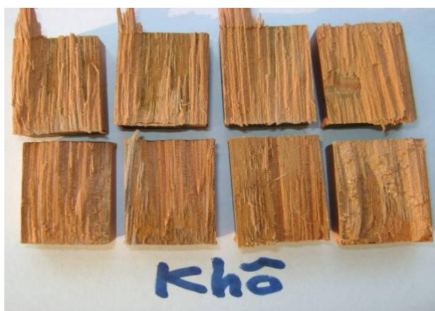
Hình 2. Màng keo bị phá hủy khi thử khô
