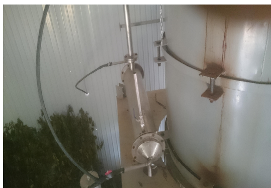
Hình 3. Bộ phận phân ly tinh dầu đặt trên sàn thao tác
