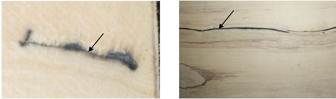
Hình 2. Hình ảnh vết nhựa đen trên mặt cắt ngang (trái) và mặt cắt xuyên tâm (phải)
