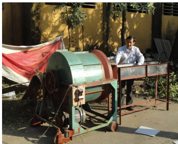
Hình 4. Thử nghiệm mẫu 2 máy băm nghiền cành lá vỏ cây tại xưởng chế tạo
