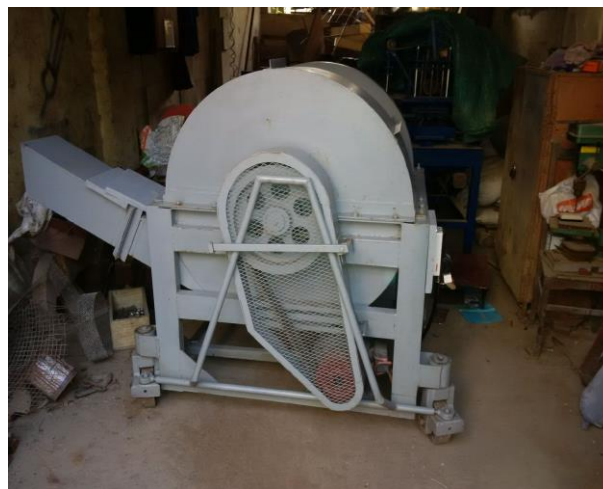
Hình 5. Máy băm nghiền cành lá vỏ cây rừng sau khi cải tiến hoàn thiện
