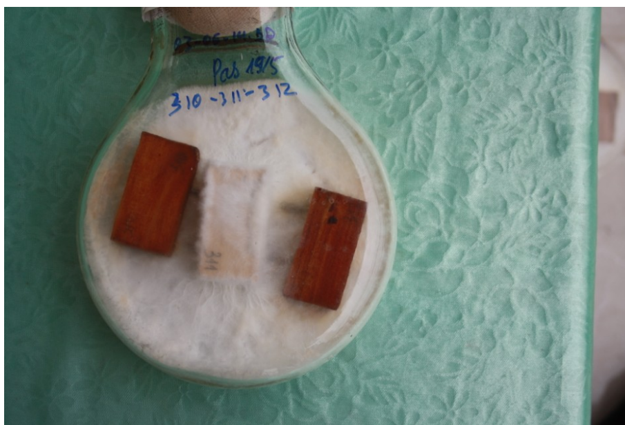
Ảnh 1. Mẫu gỗ Bò đề tẩm PF phân tán nano TiO 2 thử nấm Pleurotus ostreatus (Mẫu thử ở 2 bên, mẫu đối chứng ở giữa)
