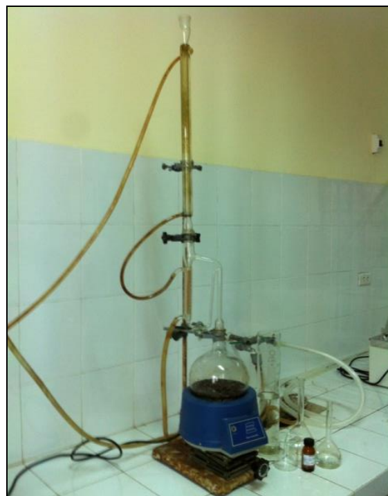
Hình 2. Bộ thiết bị chưng cất tinh dầu thực vật
