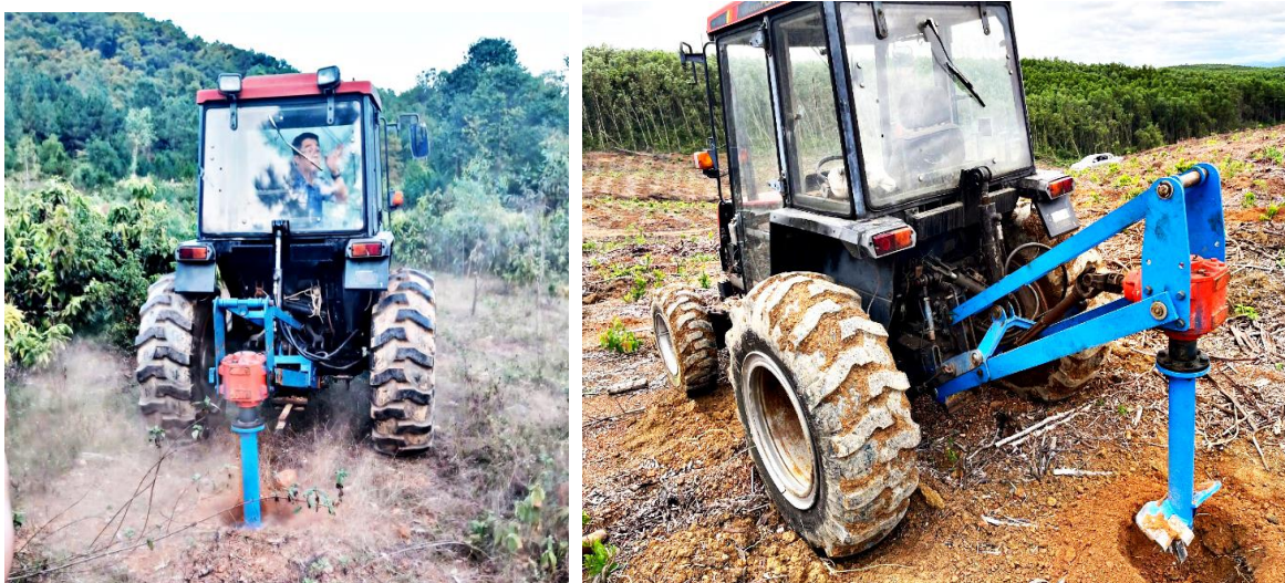
Hình 17. Liên hợp máy tạo hồ trồng rừng được khảo nghiệm tại Phú Thọ và Quảng Trị
