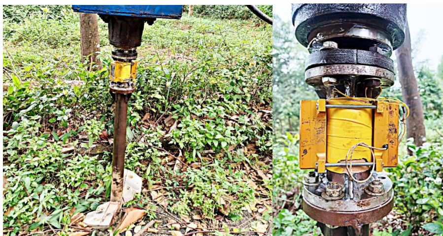
Hình 2. Hệ thống đo xác định mô men cản trên trục khoan
