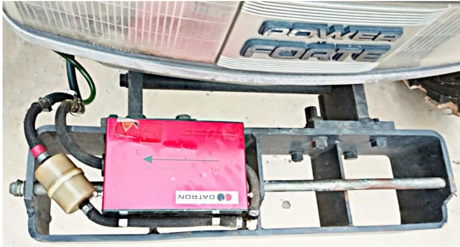
Hình 3. Thiết bị đo lưu lượng tiêu hao nhiên liệu Datron
