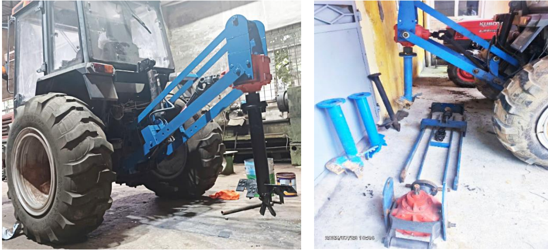
Hình 16. Hình ảnh của máy tạo hồ trồng rừng sau khi chế tạo lắp ráp và thử nghiệm
