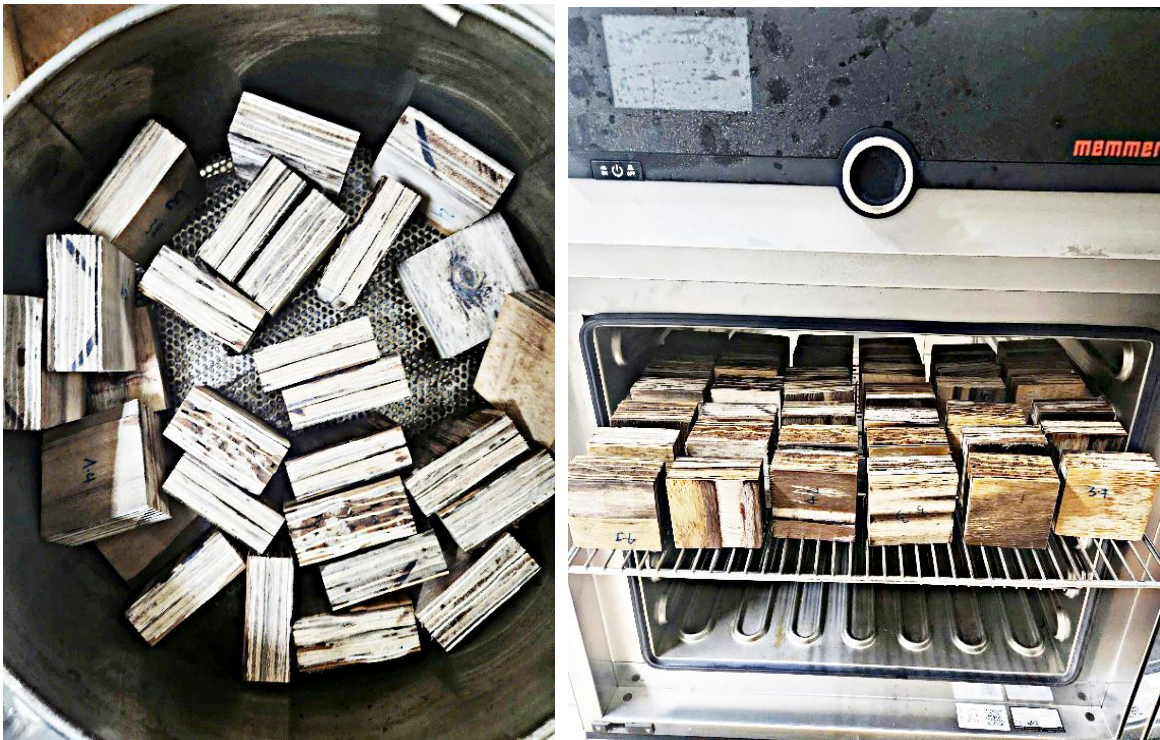
Hình 2. Xử lý mẫu thử bong tách
