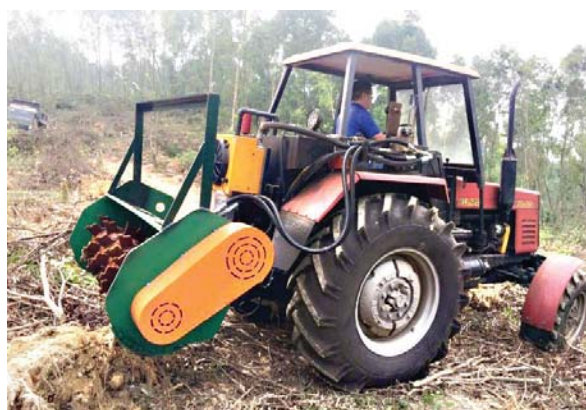
Hình 13. Thiết bị xử lý thực bì, VLHC liên hợp với máy kéo MTZ 82
