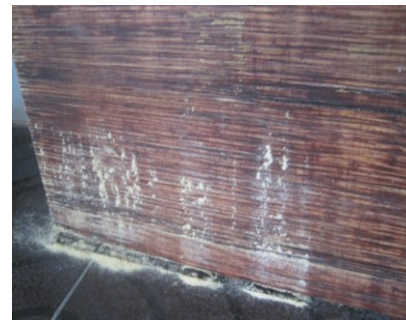
Hình 2. Cốp pha tre bị một tấn công
